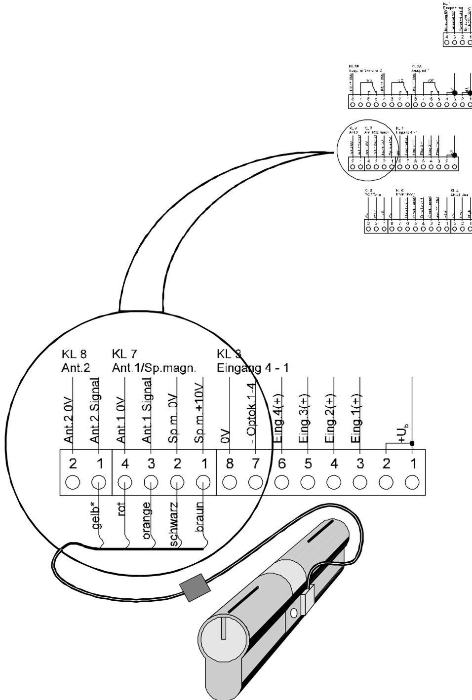
\* Der gelbe Anschlussdraht wird nur bei Zylindern mit zwei Antennen angeschlossen
